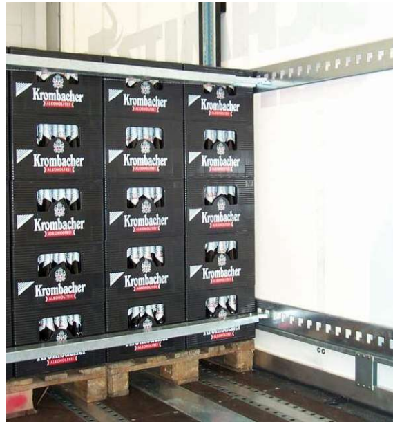
Bild 1. Rückwärtige Ladungssicherung mit Sperrbalken
