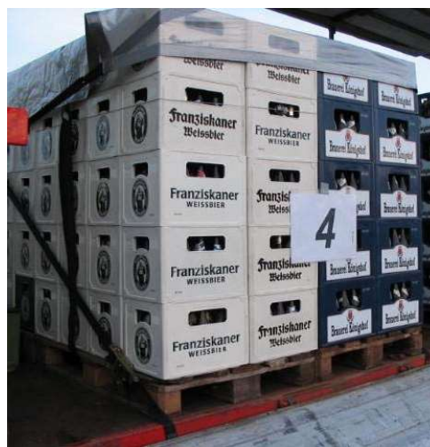
Bild 4. Seitliche und rückwärtige Ladungssicherung mit einem Zurrnetz auf einem Verteilerfahrzeug
