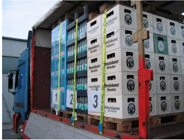
Bild 5. Seitliche und rückwärtige Ladungssicherung mittels Gurt und Palette
