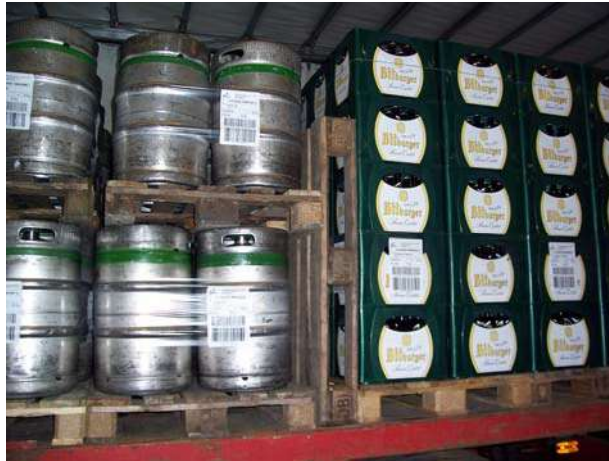
Bild 7. Holzpaletten zwischen Ladeeinheiten als flächige Abstützung
