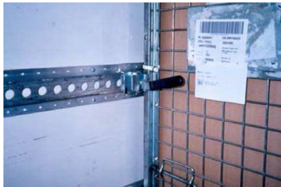
Bild 6. Sicherung eines Rollcontainers mit einer Klemme
